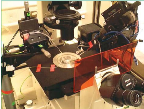
Aparat używany dla monitorowania potencjałów elektrycznych pojawiających się na synapsach
